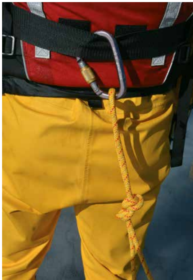
Innfesting av tau.
