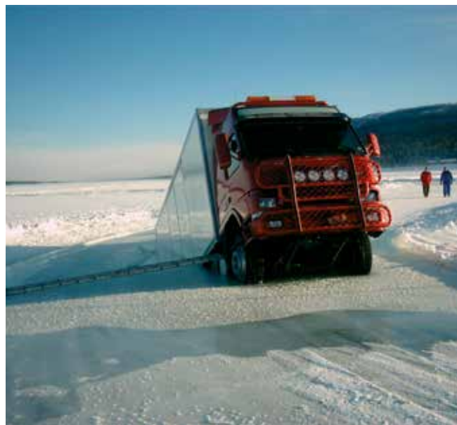
En svakhet i stålisen som medførte at en lastebil gikk gjennom.
